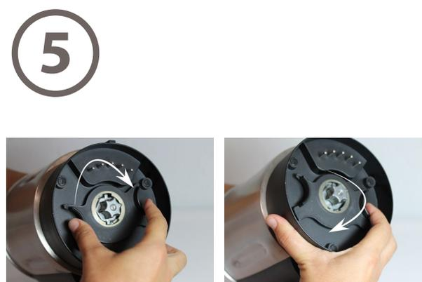
5. Gire la arandela de fijación 30° en sentido de las agujas del reloj hasta que escuche un "click". (Para efectuar el desmontaje, realice la operación inversa).
